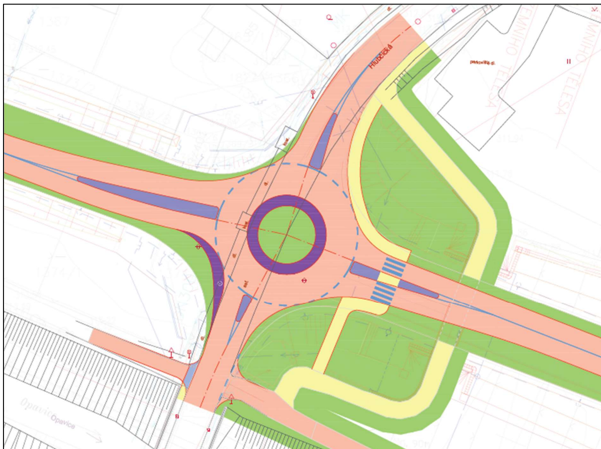
Obrázek 85 - Řešení křižovatky SV obchvatu s ulicí Hlubčická (Zpracování ČVUT)
