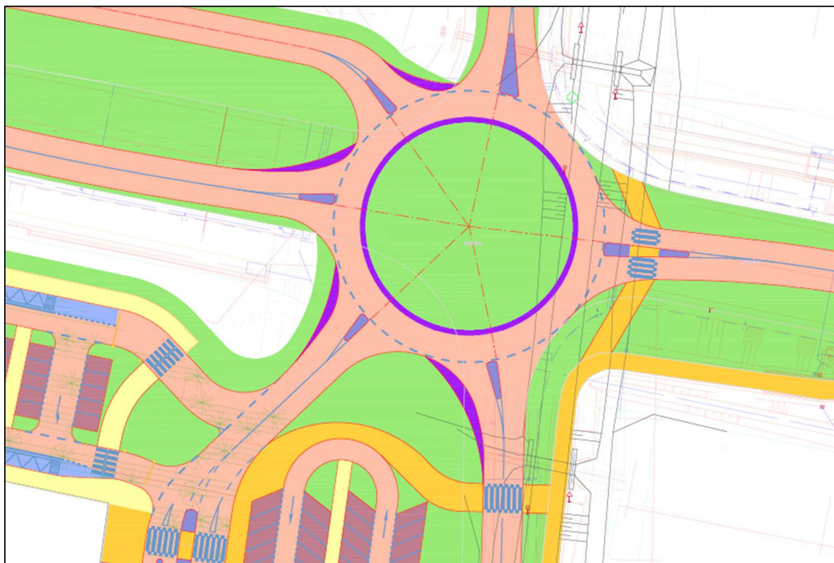
Obrázek 84 - Řešení křižovatky SV obchvatu s ulicí Petrovická (Zpracování ČVUT)
