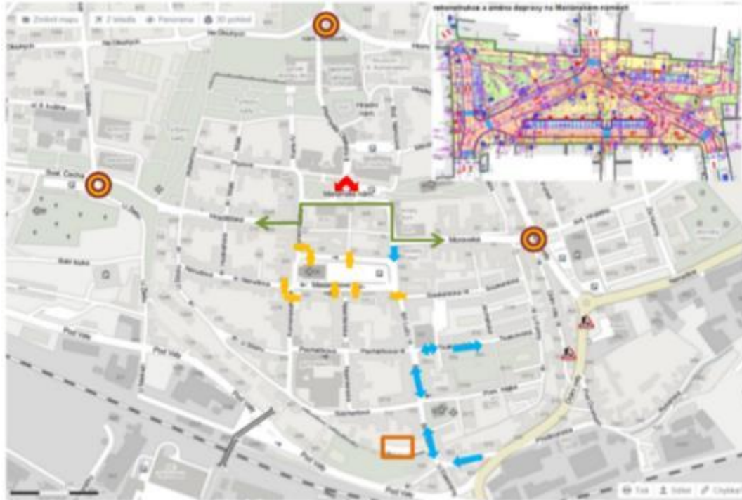
Obr.77. Mouhý princip odstranění zbytných prjezdů, IAD, zvýšení bezpečnosti chodců a zachování prjezdů vozidel HD centrem města (zdroj: Mapy.cz)
