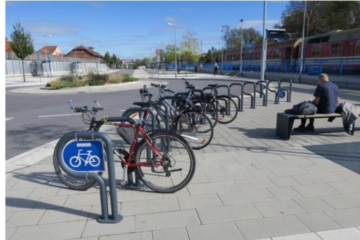
Obrázek 9.3: Příklad správného provedení stojanů u vlakového nádraží. Stojany umožňují zamčení celého kola i rámu a jejich odcizení je tím více znemožněno.
