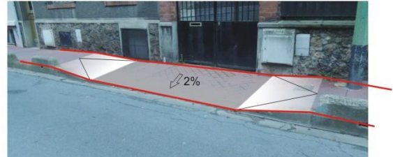
Obr. 5 – Vertikální obrubníková rampa (vlevo) Paralelní obrubníková rampa (vpravo) (Zdroj a úpravy:
