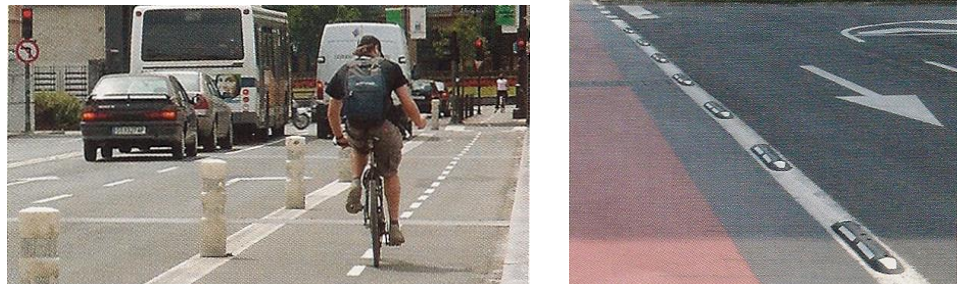
Obr. 12 – Cyklopruhy s transparentním značením, které lze snadno překonat (Zdroj: Manual de las vías ciclistas de Gipuzkoa, Diputación Foral de Gipuzkoa, 2006)
