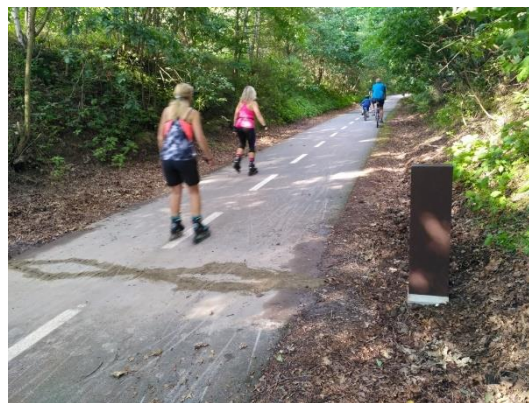
Obr.41. Automatický sčítač s kombinací tepelného a indukčního čidla (Kraj Vysočina)
