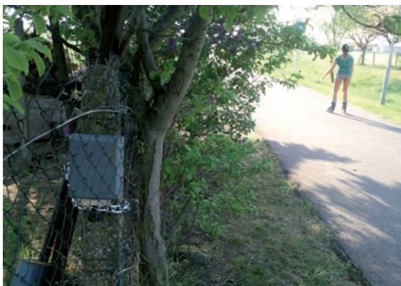
Obr. 40. Automatický sčítač s tepelným čidlem (Jihomoravský kraj)
