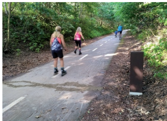
Obr. 41. Automatický sčítač s kombinací tepelného a indukčního čidla (Kraj Vysočina)
