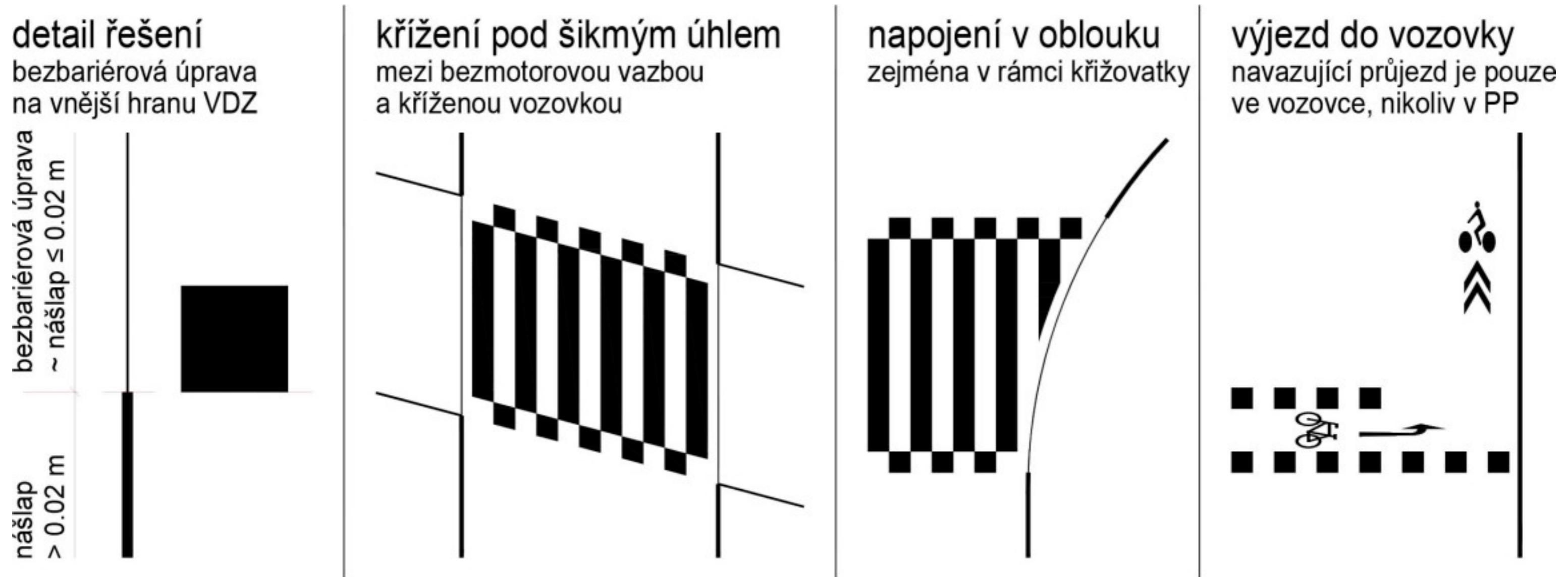
Obrázek 29 – Přejezdy pro cyklisty – detail napojení, křížení šikmé a v oblouku, výjezd do vozovky
