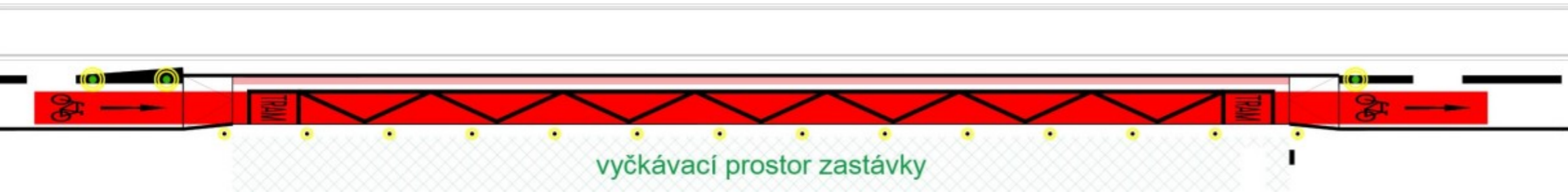
Obrázek 51 – Zastávka se zvýšeným cyklistickým pásem v rámci vyhrazeného jízdního pruhu pro cyklisty
