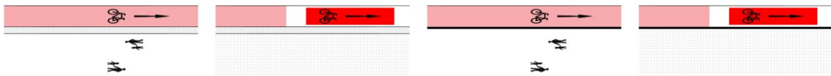
Obrázek 24 – Stezka pro chodce a cyklisty dělená jednosměrná (s hmatným pásem / bez hmatného pásu)
