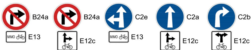
Obrázek 59 – Značení před křižovatkami s povoleným směrem jízdy cyklistů navíc oproti ostatním vozidlům
